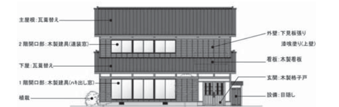
図2 「街なみ修景助成金」における目標建築物像 (出典: 参考文献9)
